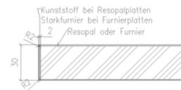
**Platte D:** 30 mm stark, aus 28 mm Mehrschichtgütespanplatte E1, Plattenoberseite wahlweise Kunststoff HPL oder Furnier aus BRUNE®-Kollektion. Plattenunterseite HPL weiß bzw. Buche Furnier. Kante Buche-Massiv-Einleimer, glatt gefräst, 9 mm stark.
