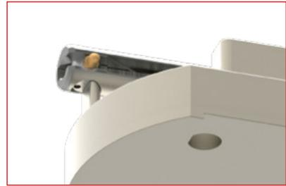
Darauf achten, dass die Bohrung mit dem Spreizstift vollumfänglich frei bleibt. Anschliessend Werkzeug festklemmen.
