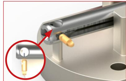
Neues Messer mit den Schneidkanten nach oben in den Messerhalter einführen. Darauf achten, dass das Messer auf der Seite des Markierungsstrichs hineingeschoben wird.
