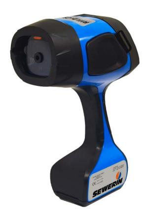
Der **RMLD-CS** ist als methansensitives optisches Verfahren laut TRAS 120 zur Überprüfung von Membransystemen auf Leckagen zugelassen.
