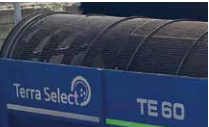
2,200 mm trommel diameter
