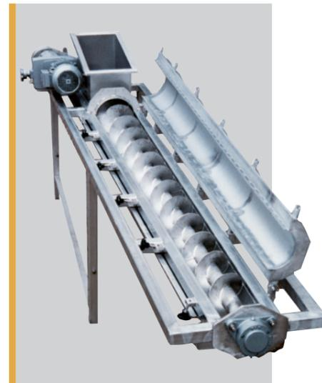
Rohrförderschnecke, obere und untere Rohrhalbschale auf- bzw. abklappbar zur Verbesserung der Reinigungsmöglichkeit
