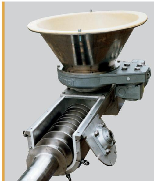
Trogförderschnecke mit schnell demontierbarer Stirnwand und Schneckenachse für Reinigung
