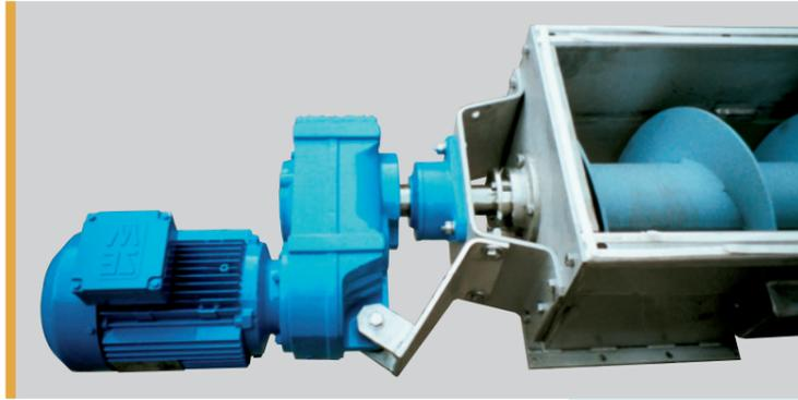
Trogschnecke mit abgesetzter Lagerung und Stopfbuchsenabdichtung
