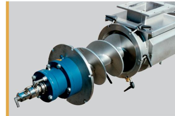
Trogschnecke einseitig gelagert, mit Wellen- und Mantelkühlung und ausziehbarer Schneckenachse
