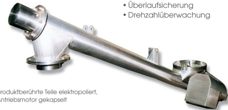
Rohrförderschnecke, produktberührte Teile elektrolytisch, Gleitringabdichtung, Antriebsmotor gekapselt (Pharmausführung)
