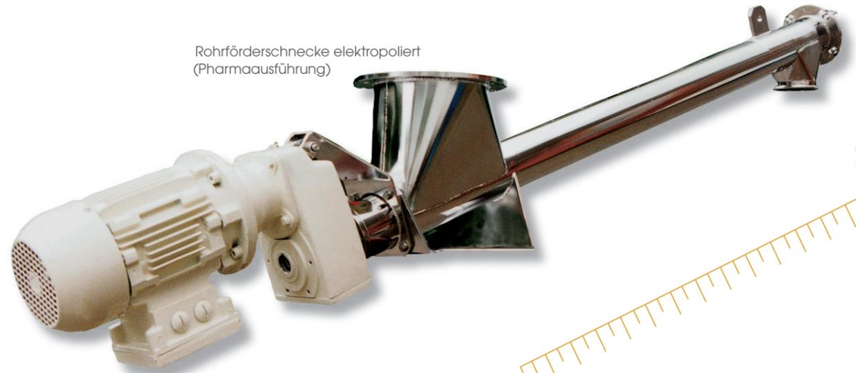
Rohrförderschnecke elektropoliert (Pharmaausführung)
