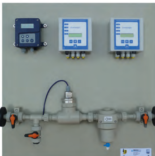
Automatische pH, Leitfähigkeits- und gleichzeitig Redox-gesteuerte Dosierung. Automatically pH-controlled, redox- controlled, and at the same time conductivity-controlled dosing.
