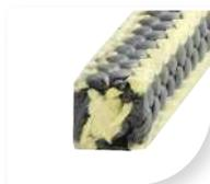
Diagonal geflochtene Packung, in der Mitte mit expandiertem PTFE, Grafito und GFO® Fasern und in den mit Aramidfasern verstärkten Ecken.
