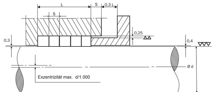
Gehäusetoleranzen (mm) und Oberflächengüte.
