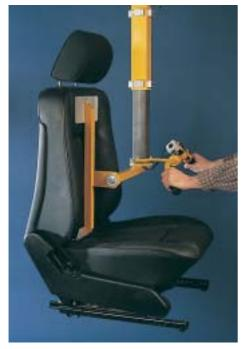
Mechanisches oder pneumatisches Werkzeug für Sitzmontage mit einem Lastgewicht von 15 - 28 kg.
