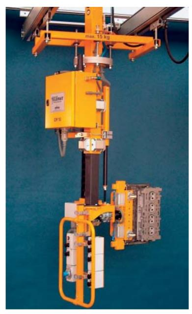
Pneumatisches Greifwerkzeug für die Handhabung von Zylinderköpfen an Bearbeitungsmaschinen mit einem Lastgewicht von 15 kg.
