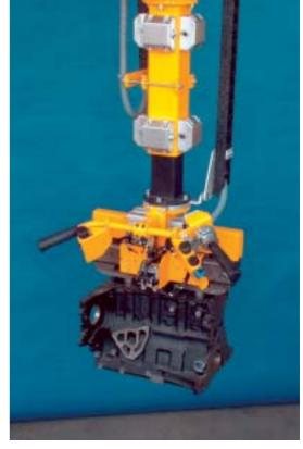
Pneumatisches Greifwerkzeug für die Handhabung von Motorblöcken an Bearbeitungsmaschinen mit einem Lastgewicht von 48 kg.
