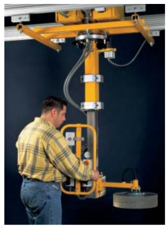
Vakuumgreifer für die Handhabung von Präzisions-Glaskörpern mit einem Lastgewicht von 40 kg.
