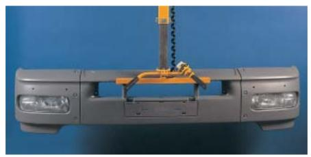
Mechanisches Gabelwerkzeug für Stoßstangenmontage mit einem Lastgewicht von 35 kg und den Abmessungen von ca. 250x450x2500 mm.
