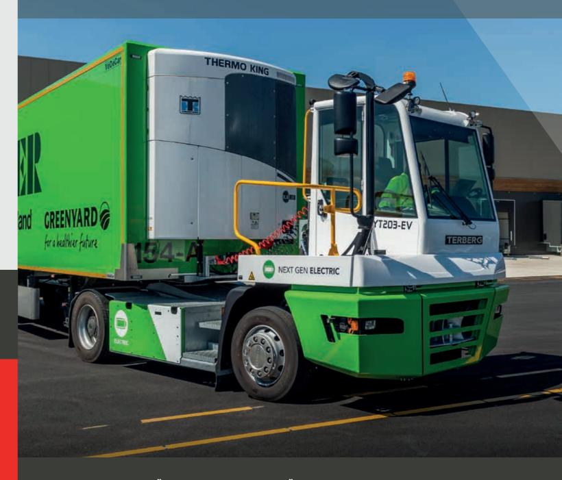
BATTERIEKAPAZITÄT VON BIS ZU 222 KWH MÖGLICH
